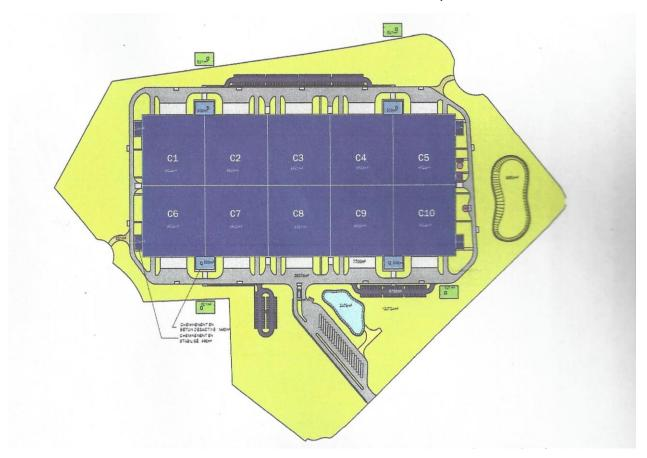
La surface totale des planchers sera de 100 474 m², dont 98 470 m² en rez de chaussée et 2 004 m² en R+1.
